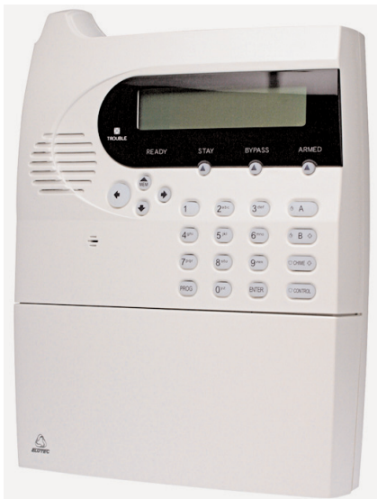
Figur 4.4 Adresserbart alarmanlegg med adresserbare detektorer
