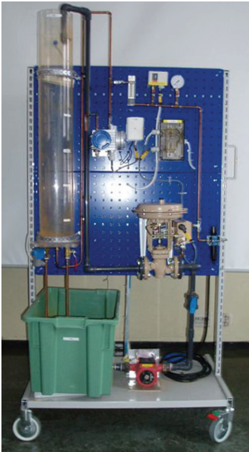
Figur 2 Prosessiden til nivåreguleringsmodell 3
