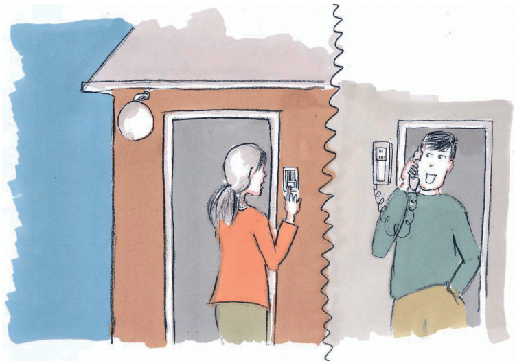
Figur 3.1 Prinsippet for et dørttelefonanlegg
