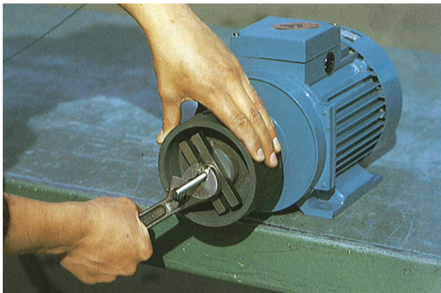
Figur 15.7 Montering av reimskive ved hjelp av en helgjenget bolt, en mutter og et par flatjern
