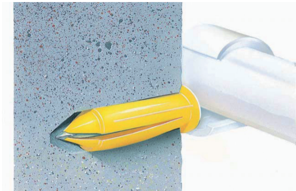
Figur 4.39 Spikerplugg i murvegg med TC-klammer
