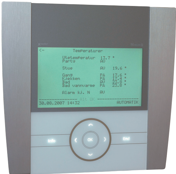
Figur 6.10 Trådløs intelligent styring og regulering av hel bolig
