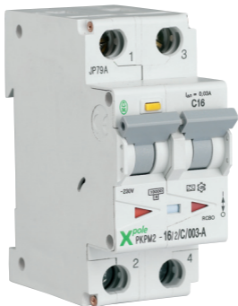
Figur 9.9 Jordfeilautomat med 16 A merkestrøm ved overbelastning og 30 mA utløsestrøm ved jordfeil
